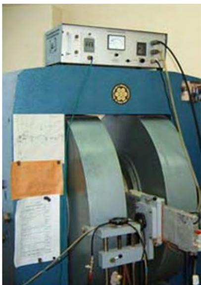
Твердотельный ЯМР спектрометр с непрерывной разверткой SWL-3-100, протонная частота 84 МГц, ядра - фтор и водород.
