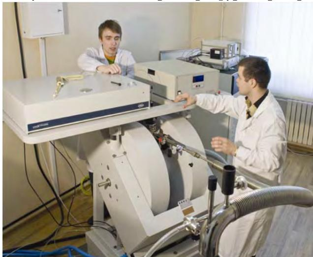
Современный стационарный/импульсный спектрометр ЭПР X/Q частотных диапазонов (9.4/34ГГц)
