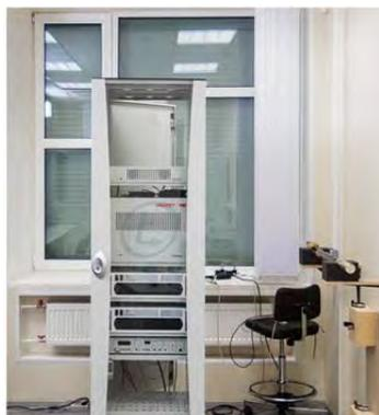
Спектрометр позволяет получать спектры ЯМР и ЯКР для исследования твердых тел, металлов, стекол и магнитоупорядоченных образцов.
