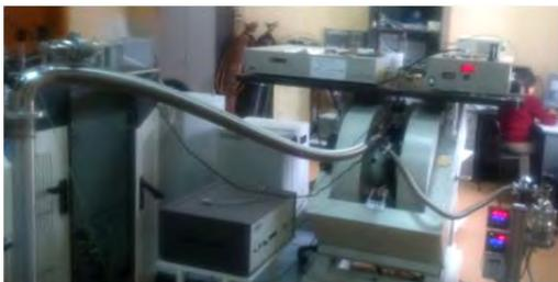
Спектрометр ЭПР и электронного спинового эха в X-диапазоне Eleksys E580 (Bruker, Германия) с температурными приставками ER4111VT, CF 935 (Oxford Instruments, температурный диапазон 4.2 – 310 K), с возможностью наблюдения двойного электрон-электронного резонанса и двойного электрон-ядерного резонанса.
