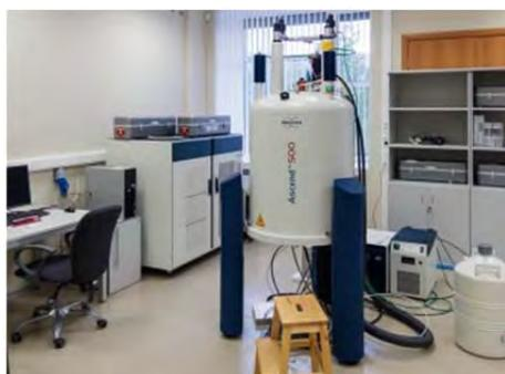
ЯМР спектрометр для измерений 1D, 2D и 3D спектров жидкостей и растворов.
