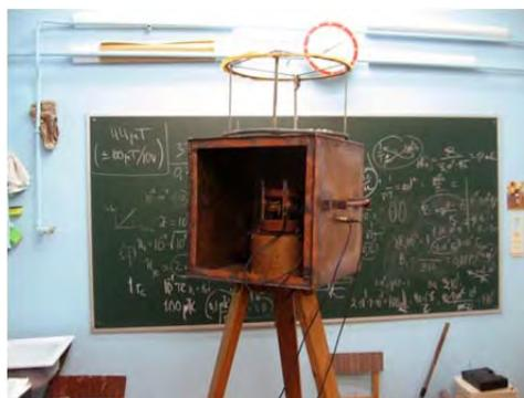
Датчик в экранирующем кубе лабораторного релаксометра-спектрометра в земном поле
