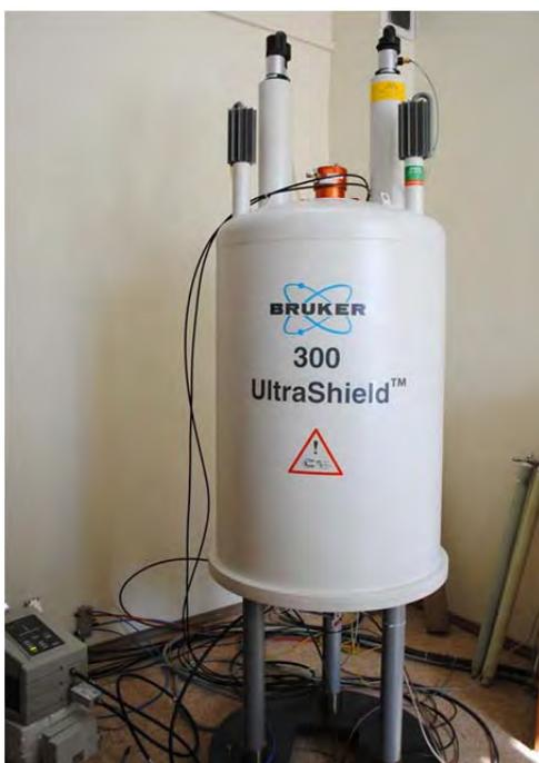
Твердотельный ЯМР спектрометр Bruker AVANCE AV 300 с возможностью съемки по  $^{19}\text{F}$ ,  $^1\text{H}$ ,  $^{109}\text{Ag}$  -  $^{31}\text{P}$ ,  $^{203}\text{Tl}$ ,  $^{205}\text{Tl}$ , MAS-датчики 4 и 7 мм со скоростью вращения до 18 кГц, возможностью съемки ядер  $^{15}\text{N}$  -  $^{31}\text{P}$  и дополнительным каналом для протонов или фтора. Мощность передатчиков H/F и X - 1 кВт, максимальная полоса SWH = 5 МГц.
