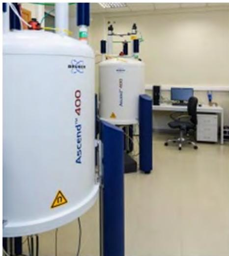
Приборы для поточных сервисных измерений 1D и 2D спектров ЯМР жидкостей и растворов.
