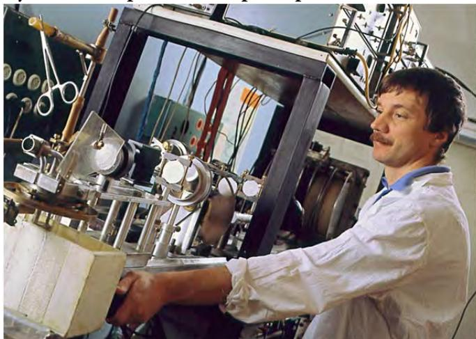
Высокочастотный спектрометр, рабочая частота которого может плавно перестраиваться в диапазоне 65 – 1250 ГГц. В качестве генераторов микроволнового излучения в этом спектрометре используются лампы обратной волны производства НПО "Исток", г. Фрязино.
