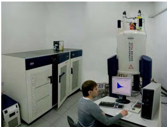
Двухканальный (X,  $^1\text{H}$ ) спектрометр твердого тела, оборудованный высокомоощным (1кВт) передатчиком, температурным блоком, пневматическим блоком для экспериментов с вращением образца под “магическим углом” (MAS).
