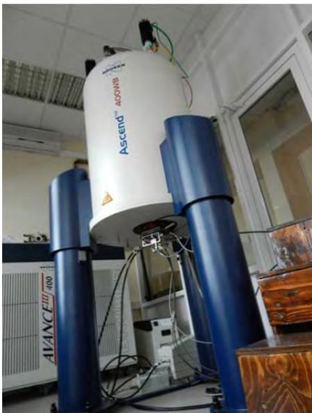
**ЯМР спектрометр Bruker Avance III 400 МГц с широким горлом**
