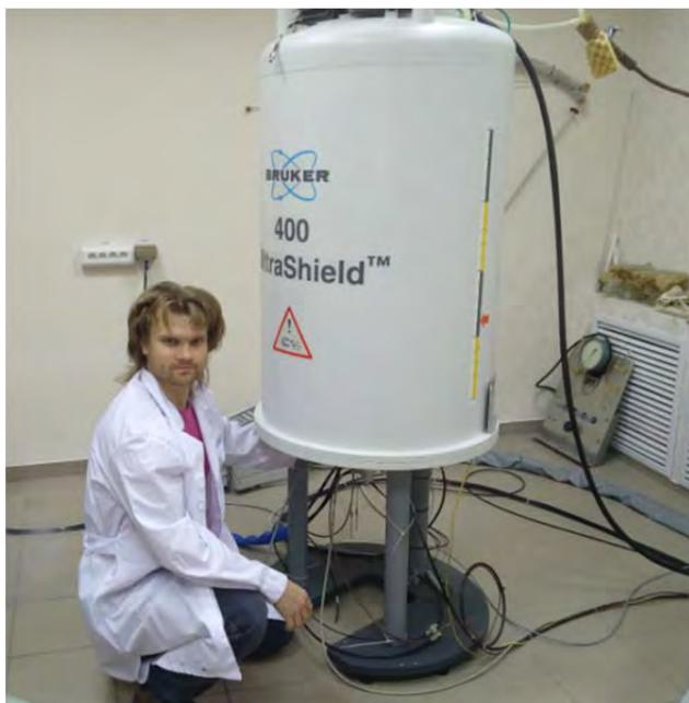
Многоядерный Фурье-спектрометр с частотой для ядер водорода 400 МГц. Позволяет получать одномерные и двумерные спектры ЯМР высокого разрешения для веществ в твёрдом и жидком состояниях. Возможно снятие спектров с динамической развязкой, измерение коэффициента диффузии с использованием встроенного градиента магнитного поля, а также времён магнитной релаксации.
