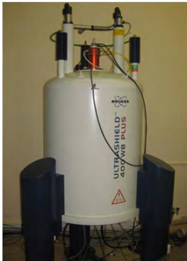
**Спектрометр ЯМР Bruker Avance-II 400WB** с полем 9,4Тс и магнитом, имеющим широкий диаметр для измерения спектров ЯМР твердых образцов.
