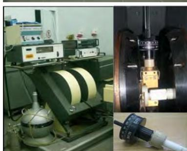
Модернизированный ЭПР спектрометр фирмы «Радиопан» с поворотным устройством (гониометром) в двух плоскостях, с цифровой обработкой сигналов.
