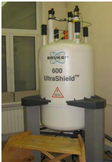
**Спектрометр ЯМР Bruker Avance 600 MHz** для измерения спектров ЯМР жидкостей.
