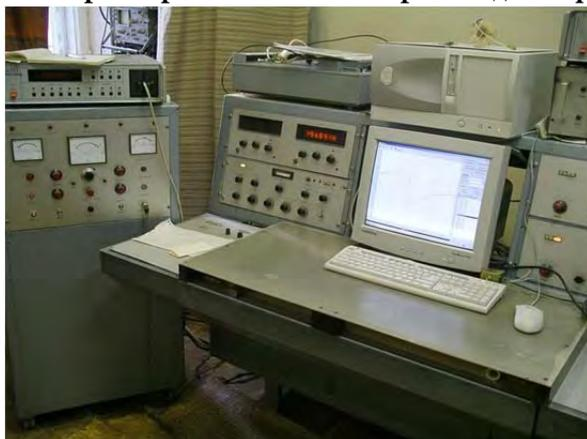
Спектрометр ЭПР BER 418 S производства фирмы "Bruker", Германия, в 2008 г. оснащен специализированным криостатом производства РНЦ "Курчатовский институт", позволяющим проводить измерения при сверхнизких температурах до 0.4 К.
