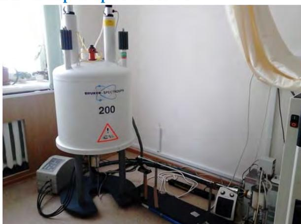
Двухканальный спектрометр ЯМР для экспериментов с динамической поляризацией
