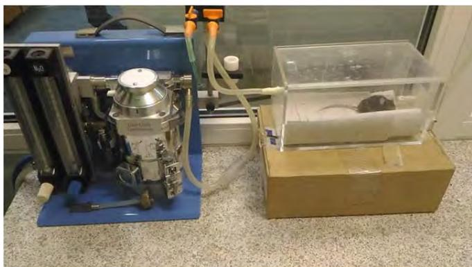
Установка для газовой анестезии лабораторных животных.
