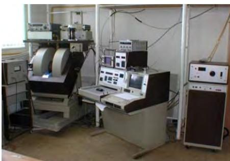
**ЭПР спектрометр Bruker ESP 300**
