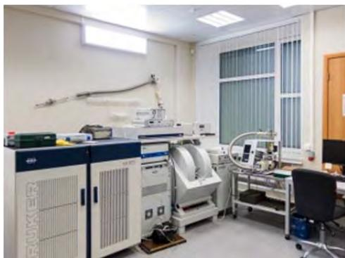
Спектрометр ЭПР ( $\lambda = 3.2$  см, X-диапазон) для изучения парамагнитных центров, локализованных в твердых телах, жидкостях, растворах, включая водные растворы и газах. Спектрометр предназначен для работы как в CW-, так и в FT-режиме.
