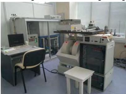
Стационарный спектрометр ЭПР X-диапазона (9 ГГц).
