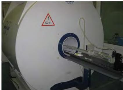
Прибор оборудован градиентной системой BGA20S2 (100 мТ/м), питание которой осуществляется с помощью блока Xantrex XPR 150-40 Mod. Биоспектротограф оснащен процессором AQS Chassis Multi-Rx, шиммирующими катушками TOSI BS30 и блоком питания BSPS12802. Управление прибором осуществляется с помощью программ TopSpin 2.0 и ParaVision 5.0.
