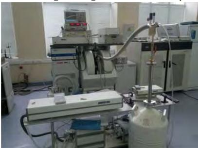
Современный стационарный/импульсный спектрометр ЭПР X/Q частотных диапазонов (9/34 ГГц)
