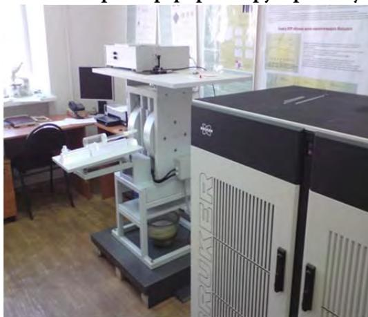
Спектрометр ELEXSYS E540, работающий в L-диапазоне на частоте 1 ГГц, снабженный устройством для ЭПР-томографии и оптимизированный для исследования биологических объектов.
