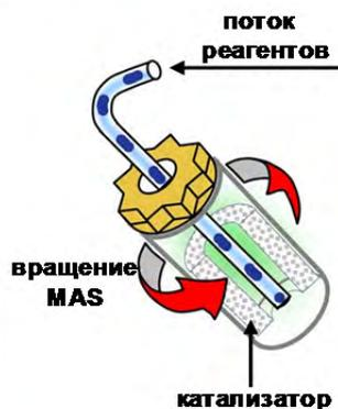
Позволяет осуществлять эксперименты с вращением образца под “магическим углом” в условиях непрерывного потока газообразных реагентов через слой адсорбента/катализатора.<sup>1</sup>
