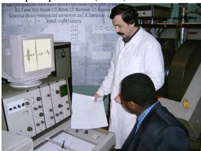
Для исследования в стационарном режиме в X (9,3 ГГц) и Q (37 ГГц) диапазонах и при температурах 4,2, 77 К и 300 - 500 К. Имеется приставка ДЭЯР. Максимальное магнитное поле в X-диапазоне 1.6 Тл, в Q- диапазоне 2.2Тл
