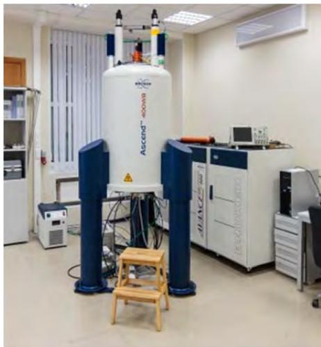
Спектрометр для исследования образцов в твердой фазе: кристаллов, порошков, слабоупорядоченных сред и материалов, гелей, жидких кристаллов, аморфных сред, наноструктур (цеолитов, силикатов) и т.п., а также для исследования процессов диффузии и получения микротомографических изображений.
