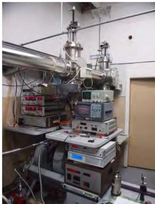
Спектрометр ЭПР с временным разрешением для фотохимических и фотофизических исследований.
