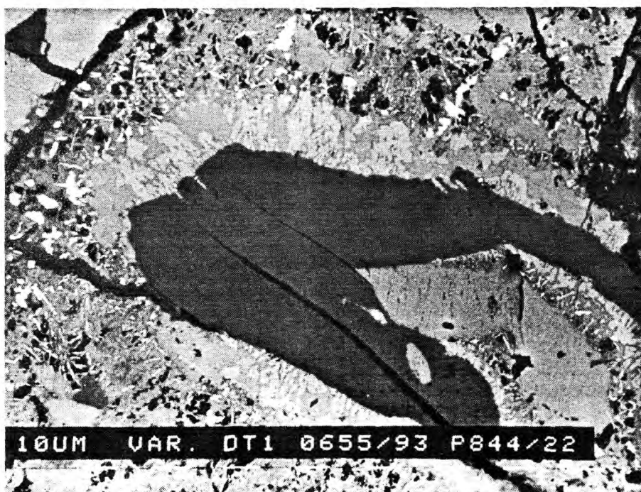
Рис. 1. Подковообразное выделение судовиковита (темная фаза) с коронарным обрамлением фазой PtBiSe (светлое) в клаусталитовой матрице (серое). Изображение получено в режиме детектирования отраженных электронов с помощью полупроводникового детектора. Размер микронного маркера (белый пунктир под кодировочной строкой) указан в начале строки.
