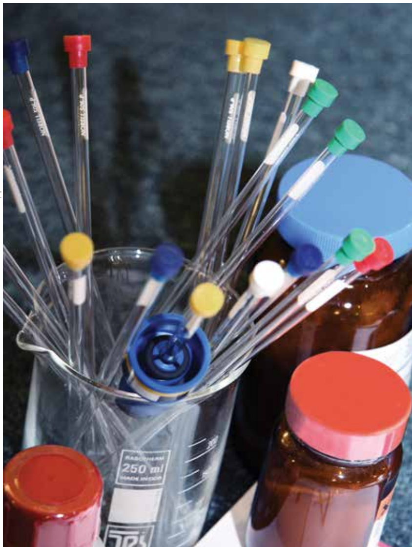
Ампулы с образцами для спектрометра ядерного магнитного резонанса. ЯМР-спектроскопия — сильная сторона научного парка СПбГУ
