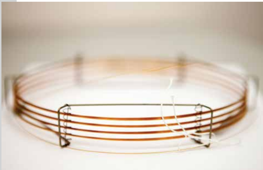
Внутри капилляра-хроматографа диаметром 0,25 мм происходит разделение смеси на отдельные компоненты
