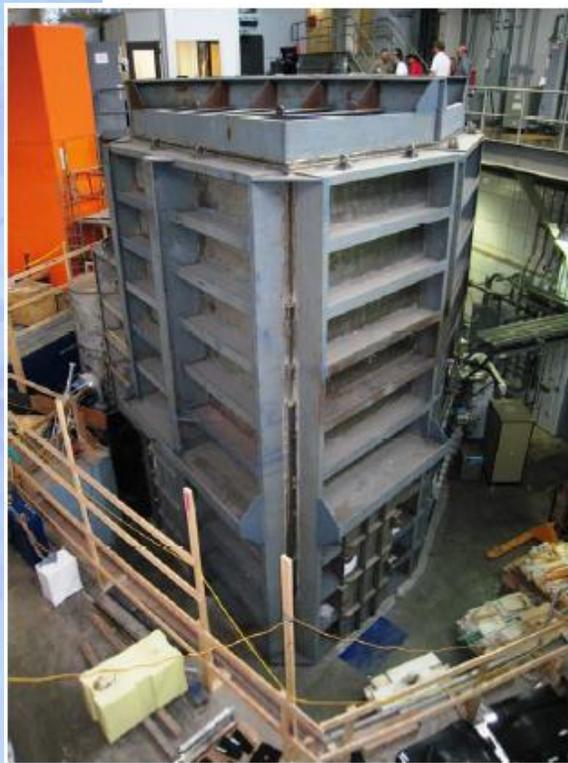
**Рис. 57.** Сегмент детектора современного нейтронного TOF-спектрометра. Эффективный телесный угол TOF-установок может составлять несколько единиц стерadian, при этом площадь позиционно-чувствительного детектора может достигать  $50 \text{ м}^2$
