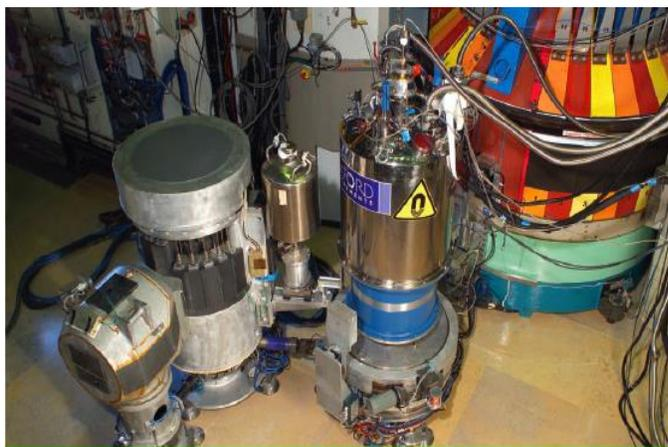
**Рис. 54.** Типичный TAS-спектрометр. Такие приборы очень гибки в исследовании возбуждений. Количество осей прибора, позволяющих варьировать параметры эксперимента, в реальности превышает число 3.
