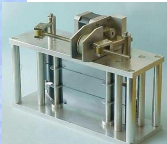
**Рис. 37.** Монохроматор с двойной фокусировкой из кремниевых кристаллов дифрактометра ARES.
