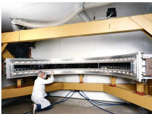
**Рис. 32.** Монтаж микроstriпового детектора для D20 (ILL).
