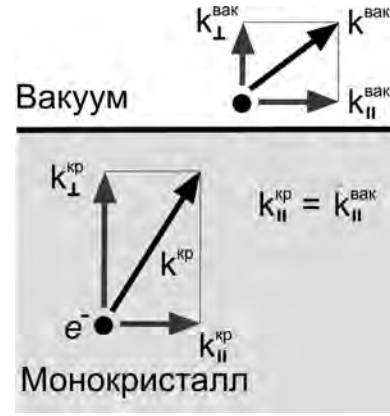
Рис. 4: Прохождение электроном потенциального барьера поверхности.
